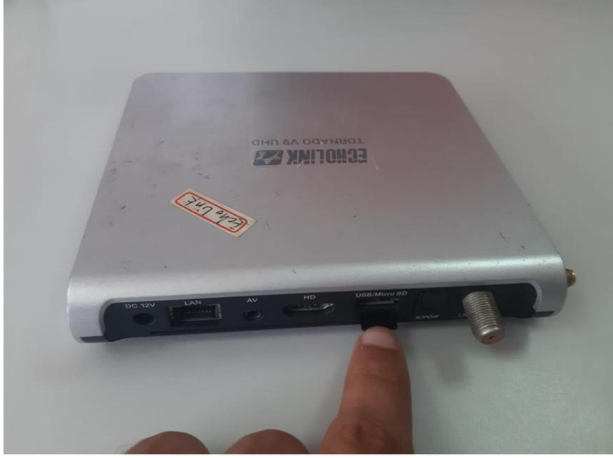
(12) إضغط على زر **Recovery** بإبرة لبعض الثواني تم قم بتوصيل الجهاز بالكهرباء حتى يصبح لون المصباح يضيء بالأزرق
